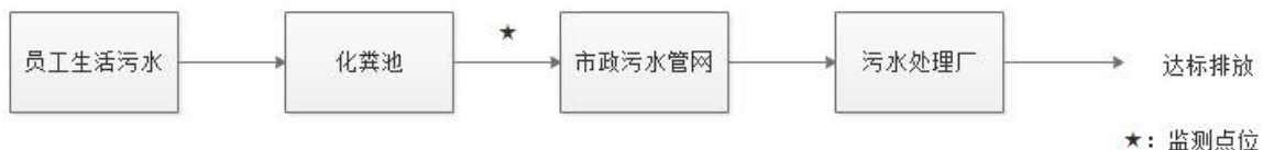
图 3-1 生活污水处理工艺流程图
